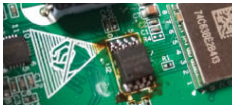
Rys. 15 Przykład śladów po manipulacji przy kości pamięci
