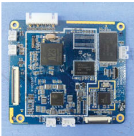
Rys. 18 Płyta główna Smart Toy z zaznaczonym portem USB.
